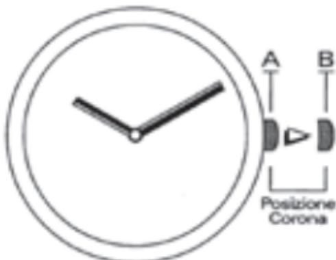
**1** Svitare la corona (se a vite) • **2** Estrarre la corona posizione B • **3** Ruotare la corona in qualunque senso per regolare l'ora • **4** Riportare la corona in posizione A • **5** Riavvitare la corona (se a vite)
