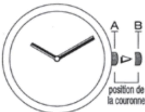
**1** Dévisser la couronne (si elle est à vis) • **2** Extraire la couronne en position B • **3** Tourner la couronne dans un sens ou l'autre pour régler l'heure • **4** Remettre la couronne sur la position A • **5** Revisser la couronne (si elle est à vis)
