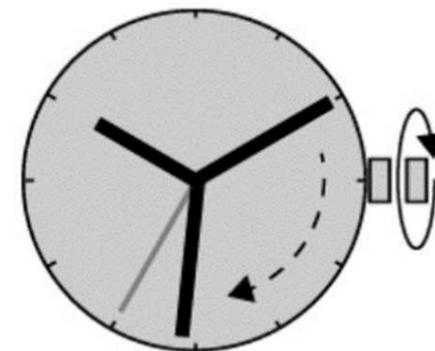
**7. При необходимости закрутите заводную головку, чтобы обеспечить герметичность и водонепроницаемость.**
