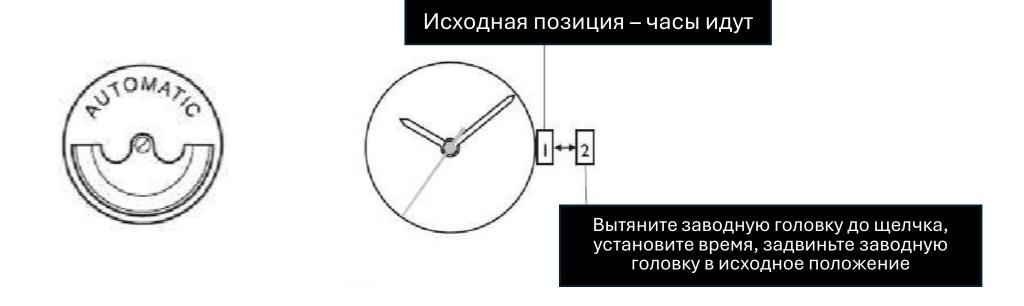
Данный механизм оснащен функцией автоподзавода – при движении Вашего запястья часы активируются
