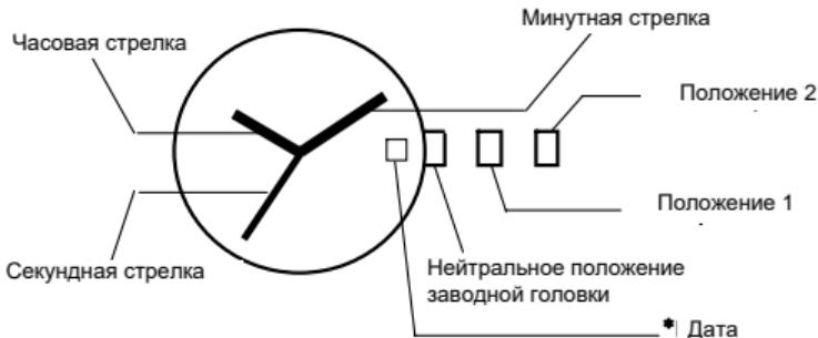
Некоторые модели имеют завинчивающуюся заводную головку: вращайте заводную головку по часовой стрелке до тех пор, пока ее будет невозможно вытащить. По окончанию регулировки закрутите часовую головку.
